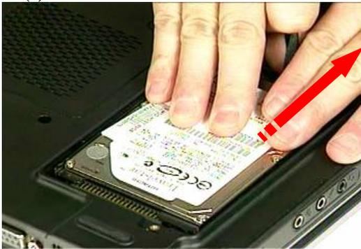
**3. Install a new HDD module.**
