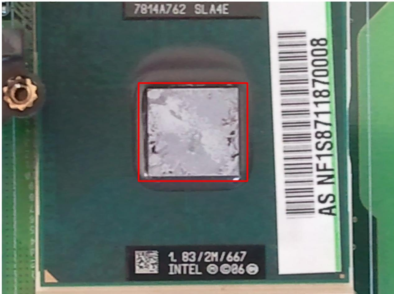
Dépôt de la nouvelle pâte thermique sur le refroidisseur du processeur. Ici la trace de la pâte d'origine toute sèche après 4 ans d'utilisation intensive.
