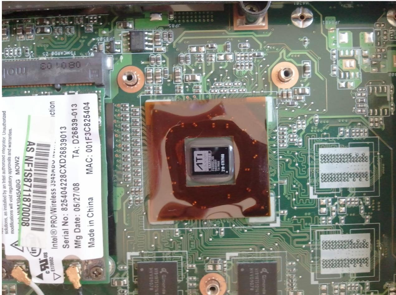
Une autre vue du processeur duo core Intel sans son système de refroidissement, à noter : la pâte thermique d'origine a complètement séché avec le temps.
